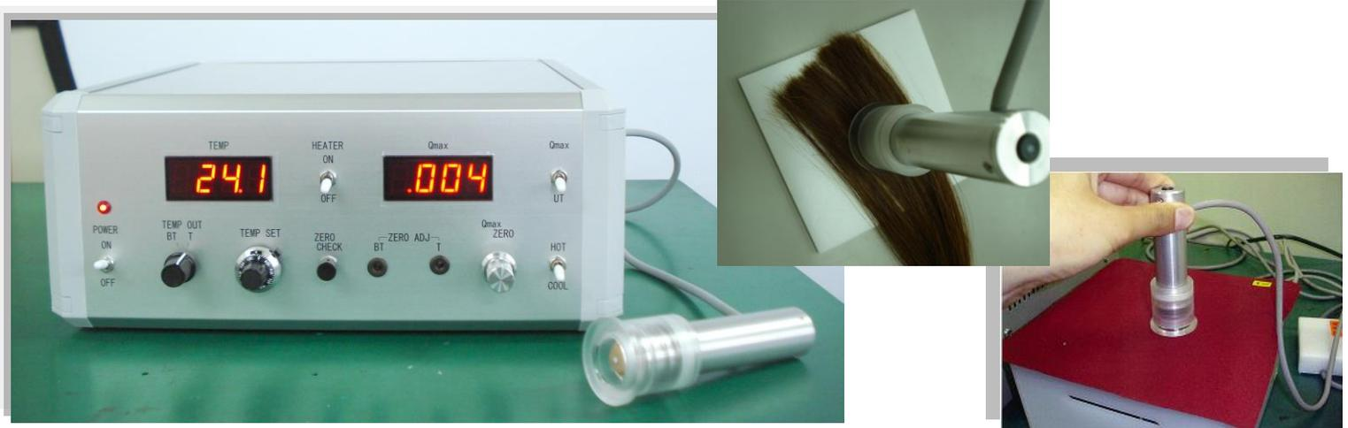
接触温度センサー部分(1mmx1.5mm)をシリコンゴム(半径 5mm、厚み 0.5mm)によって覆い、皮膚のような構造を再現しました。
